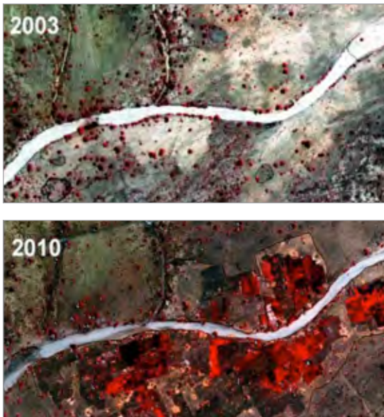
Illustration 14: Surfaces de cultures de légumes (en rouge) dans le Ouadi Chock (Tchad) avant la construction des seuils d'épandage (2003) et après celle-ci (2010) Source : BCIE (2011)
